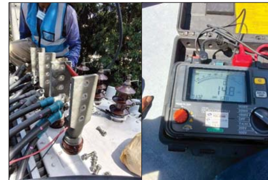
วัดค่าความเป็นฉนวนโดยรวมหม้อแปลงไฟฟ้า ด้านแรงต่ำ - กราวด์ ที่ 2500Vdc ได้ 14.8GΩ
