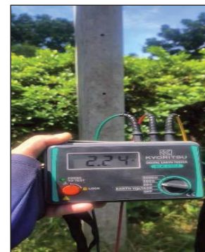
วัดค่ากราวด์ TR.1 ขนาด 2000kVA S/N.59133891EE
