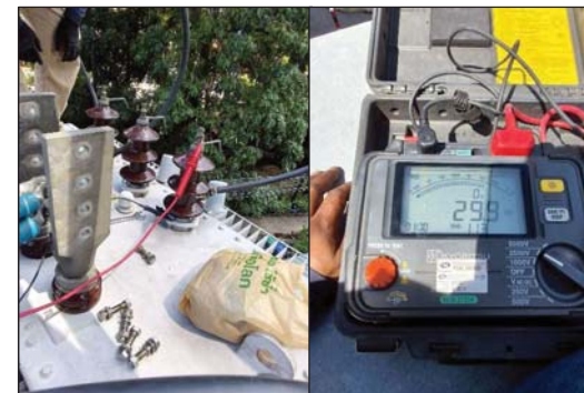
วัดค่าความเป็นฉนวนโดยรวมหม้อแปลงไฟฟ้า ด้านแรงสูง - กราวด์ ที่ 2500Vdc ได้ 29.9GΩ
