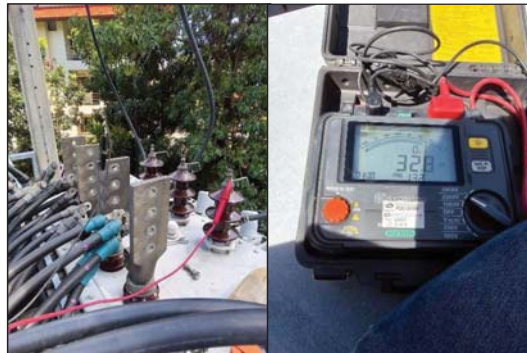
วัดค่าความเป็นฉนวนโดยรวมหม้อแปลงไฟฟ้า ด้านแรงสูง - แรงต่ำ ที่ 2500 Vdc ได้ 32.8 GΩ
