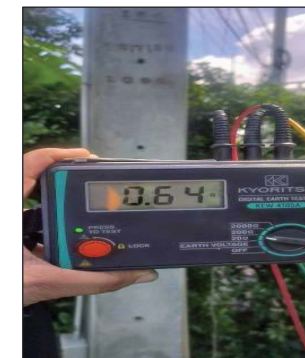
วัดค่ากราวด์ TR.2 ขนาด 2000kVA S/N.60137337EE
