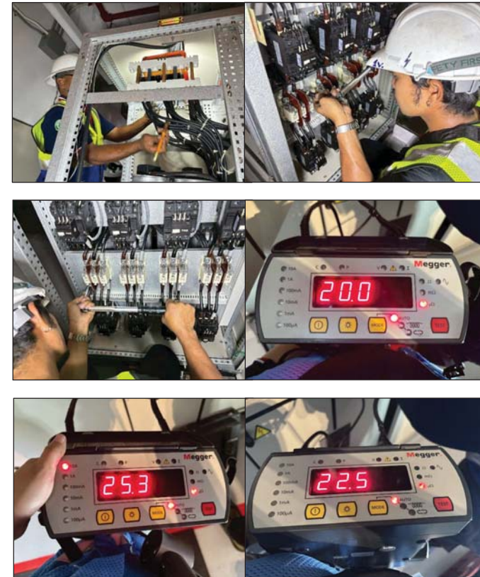
วัดค่าความต้านทานหน้าสัมผัสอุปกรณ์ (Contact resistance test)
